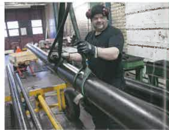
Cylinderrören levereras normalt i sexmeterslängder. Dejnäs Helgesson är först i tillverkningsprocessen där han tar emot och skickar vidare till rätt ställe.
